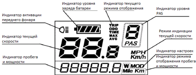
Рисунок 8. Структура дисплея LCD-пульта
