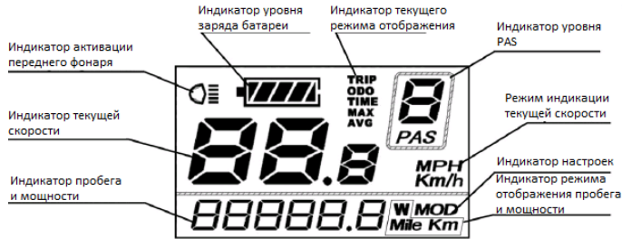
Малюнок 17. Структура дисплея LCD-пульта
